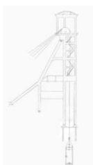
Cavalete do Poço de São Vicente e Jaula
