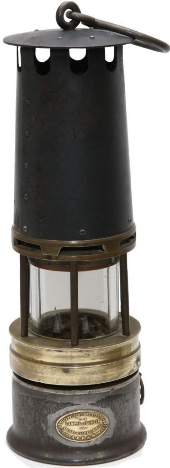
Lanterna "Wolf" Modelo: Benzina; Fabrico: SAEAEA - Société Anonyme d'Éclairage et d'Applications Électriques d'Arras França:(Arras - Pas de Calais) - 1910
