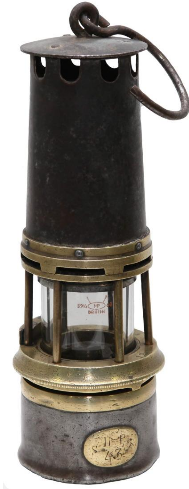
Lanterna "Wolf" Modelo: Benzina; Fabrico: SBAE (Société Belge d' Application Electrique) Bélgica (Bouverie ) - 1920
