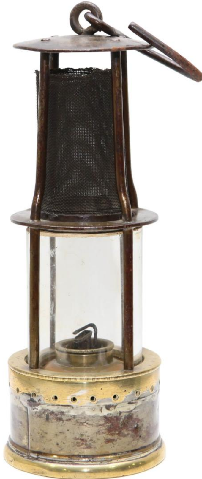
Lanterna "Clanny" Modelo: Óleo com coroa perfurada na parte inferior para alimentação de ar Fabrico: Belga; Tipo: Bernissart Bélgica -1860-70
