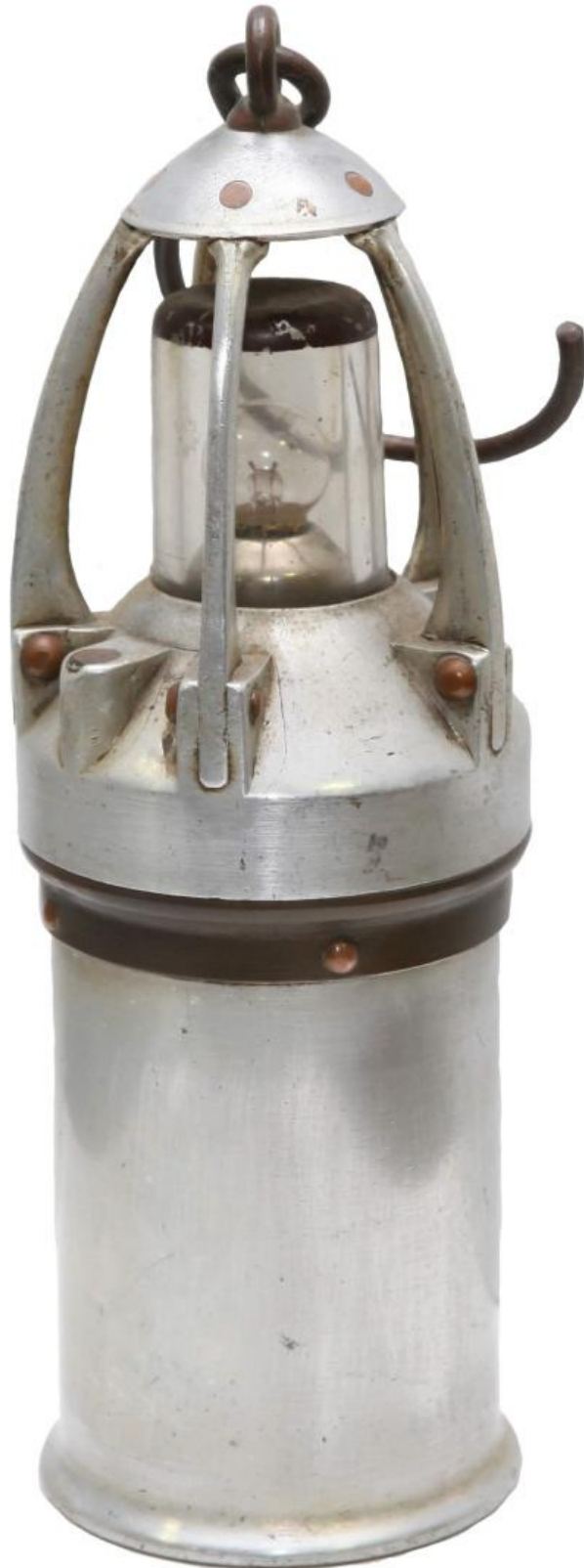
Lanterna eléctrica quadro com bateria portátil quadro Modelo: Bateria seca; Fabrico: the CEAG iners Supply Co Ltd Grã-Bretanha (Barnsley) - 1950
