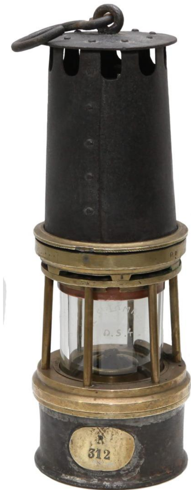
Lanterna "Marsault" Modelo: Óleo; Fabrico: Dufrasne Castiaux à Monceau Bélgica (Monceau Sur Sambre ) - 1910-1920
