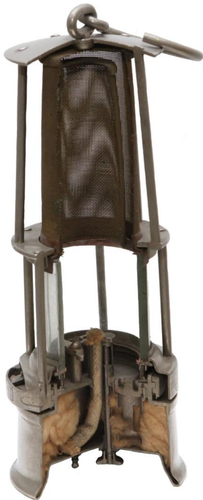
Lanterna "didática" a benzina Modelo: Benzina; Fabrico: Hubert Joris Tipo: modelo para a escola das minas Bélgica (Loncin - Liège ) - 1920
